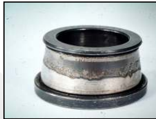
Defeito geométrico do eixo e do alojamento em rol. cônico
