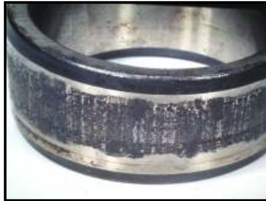
Oxidação em funcionamento (entrada de líquido)
