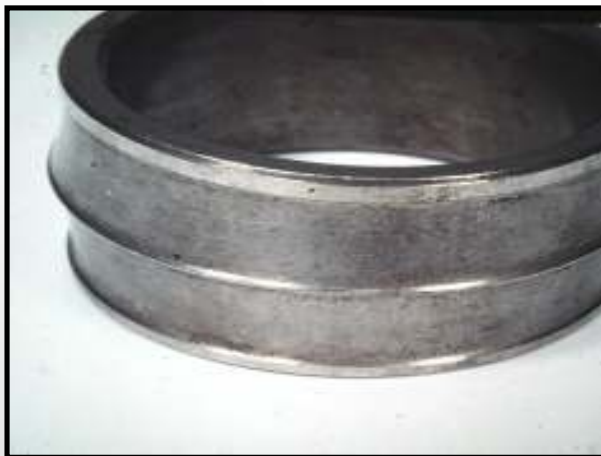
Desgaste por entrada de abrasivo
