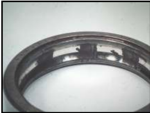
Oxidação na parada (entrada de líquido)
