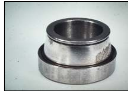
Deterioração do cone devida a um defeito de alinhamento
