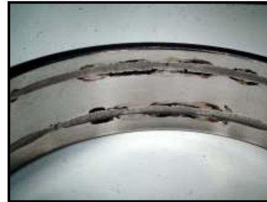
Oxidação e desgaste em funcionamento (entrada de líquido e relubrificação)
