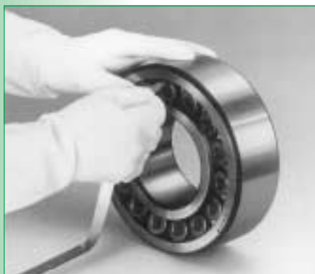
Figura 1 - Medição de Folga no Rolamento Autocompensador de Roos
