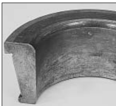
10 Corrosão de contato
